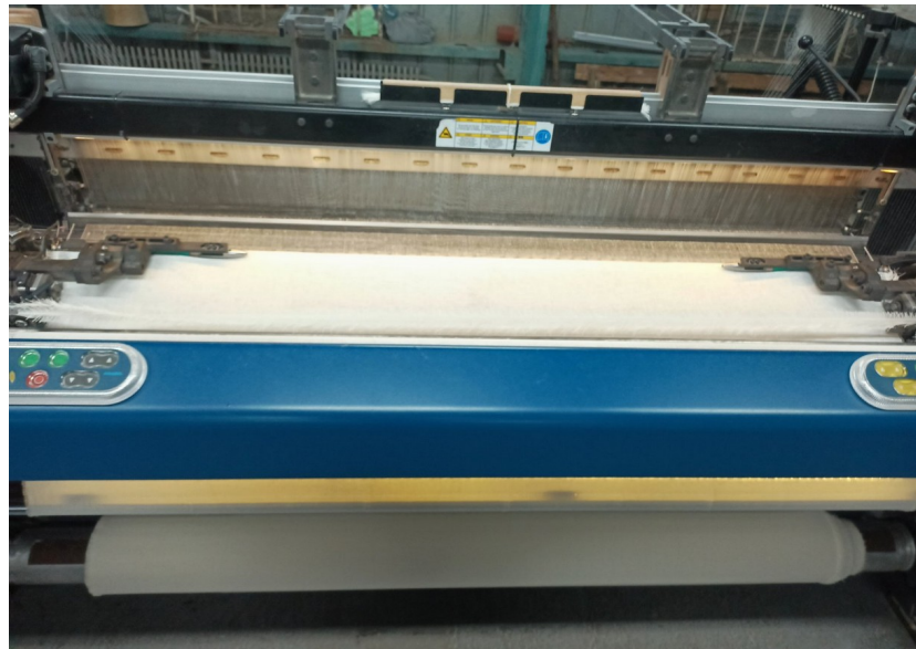
Рис. 6 – Виготовлення нових зразків тканини на ткацькому верстаті СТБ-4-180
