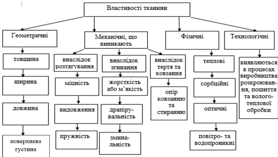
Рис 2.7 – Класифікація властивостей тканих полотен для взуттєвого виробництва
