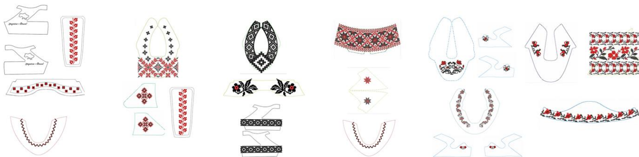
Рис. 4.11 – Проект крою деталей розробленого взуття з декоративною вишивкою
