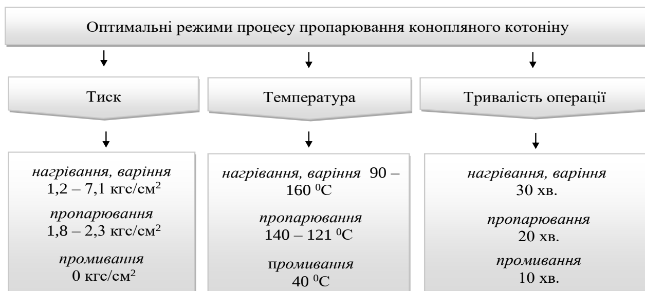
Рис. 3.4. – Схема раціональних режимів пропарювання модифікованого конопляного волокна
