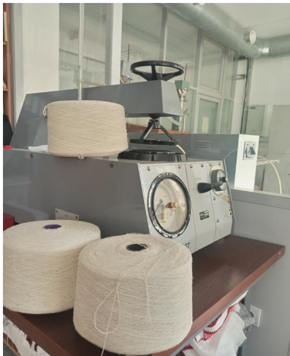
Рис. 3.16 – Зразок пряжі, отриманої пневмомеханічним способом прядіння у виробничих умовах.
