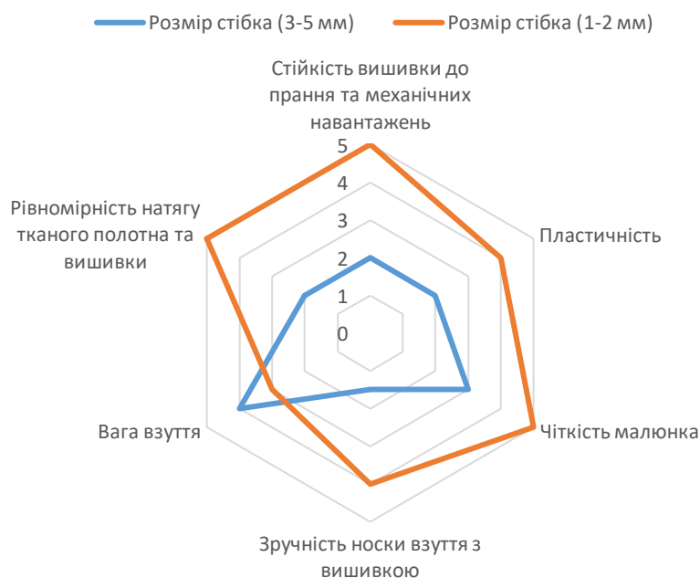
Рис. 4.14 – Профілограма органолептичного дослідження якості тканого полотна верху взуття з вишивкою різною за розміром стібка
