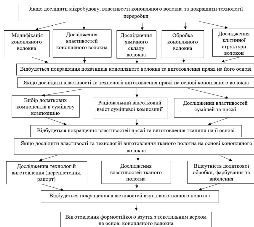
Рис. 1.9 – Багатостадійна гіпотеза залежності формостійкості текстильного взуття від формування показників властивостей текстильних матеріалів
