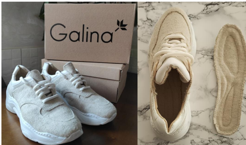
Рис. 4.7 – Експериментальні зразки текстильного взуття з верхом із тканого полотна з модифікованого конопляного волокна
