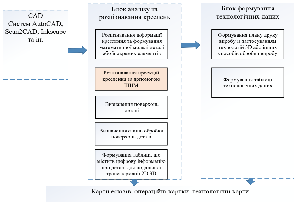
Рисунок 1.3 Модель автоматизованої підготовки виробництва на основі розв'язання задач розпізнавання креслень та їх трансформації 2D→3D
