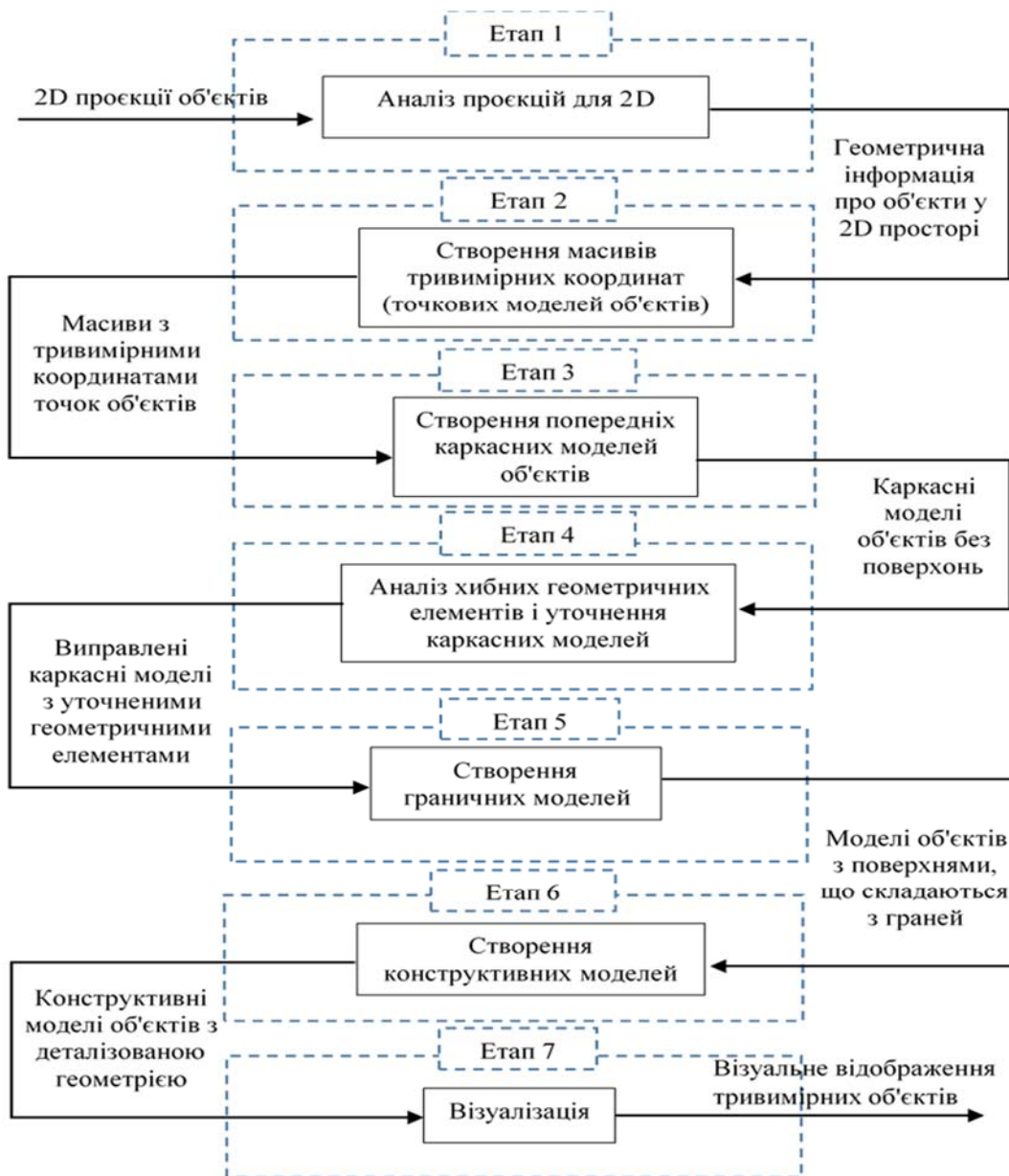
Рисунок 1.2. Модель трансформації 2D зображень у 3D модель в класичних підходах
